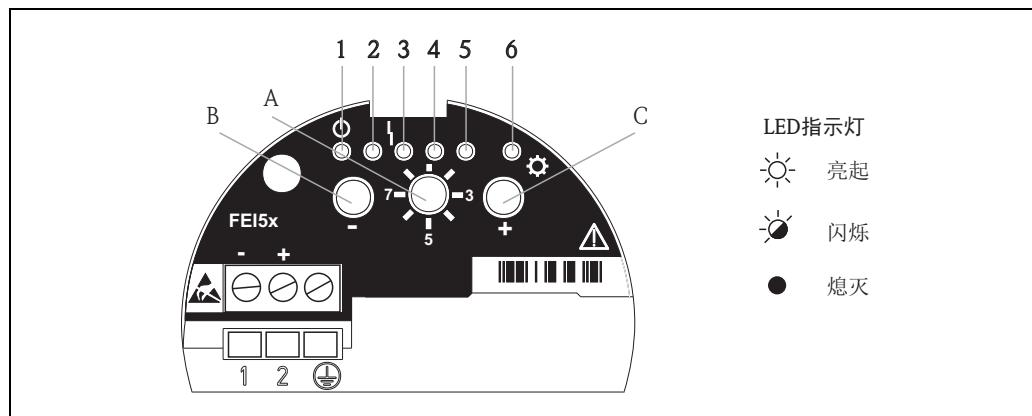
绿色 LED 指示灯 1 (Φ: 可以工作)；红色 LED 指示灯 3 (!: 故障)；黄色 LED 指示灯 6 (\*: 开关状态)
