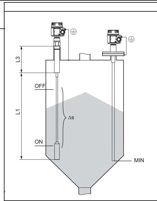
**测量非导电性介质时的最小传感器长度 (<1μs/cm)**
