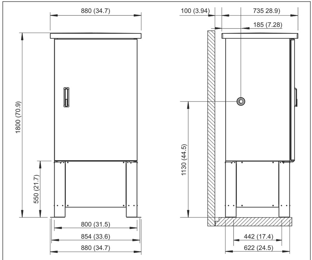
图 6 标准型柜体的外形尺寸示意图，带基座；单位：mm (inch)
